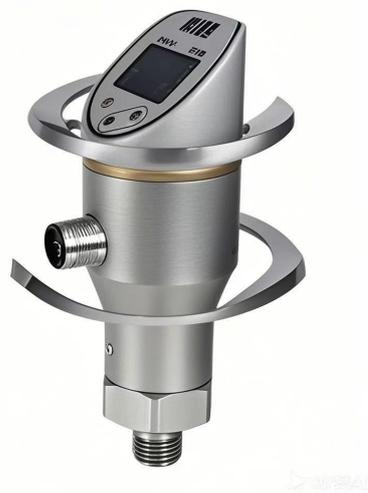
PK40X 系列开关量压力变送器主要由测压元件传感器（也称作压力传感器）、测量电路和过程连接件三部分组成。它能将测压元件传感器感受到的气体、液体等物理压力参数转变成标准的 4...20mA 模拟信号，同时通过运算处理的信号来控制两路 PNP 开关输出，对控制系统压力进行测控。开关量可在零点和满度之间任意设定，并具有迟滞、窗口切换功能。并具有节点指示灯和屏幕压力显示功能。广泛用于石油、化工、机械、液压等对流体介质的压力测量显示和控制等相关行业。
